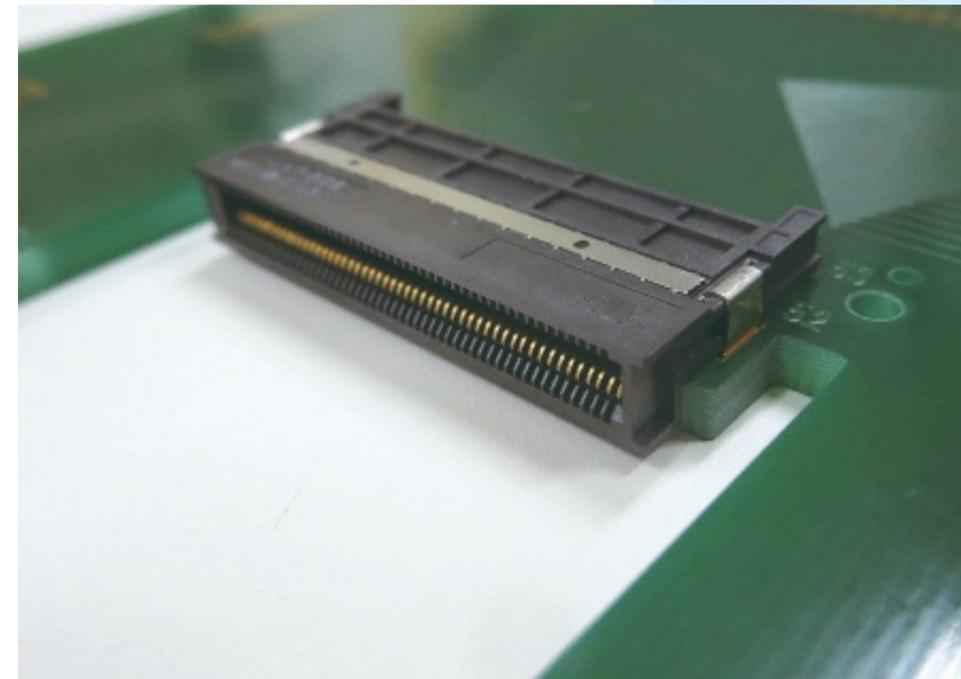
**Abb.3:** Host-Connector in „Mid-Mount“-Technologie, in das PCB versenkt.
